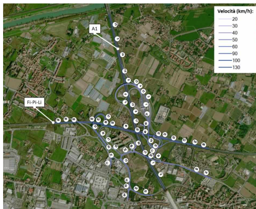
Figura 5-10: Rete di riferimento per l'analisi emissiva dello stato attuale e velocità di percorrenza
