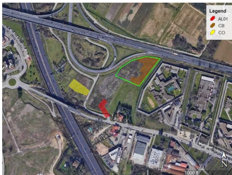
Figura 8-3 Rappresentazione sorgenti areali implementate in Aermod
