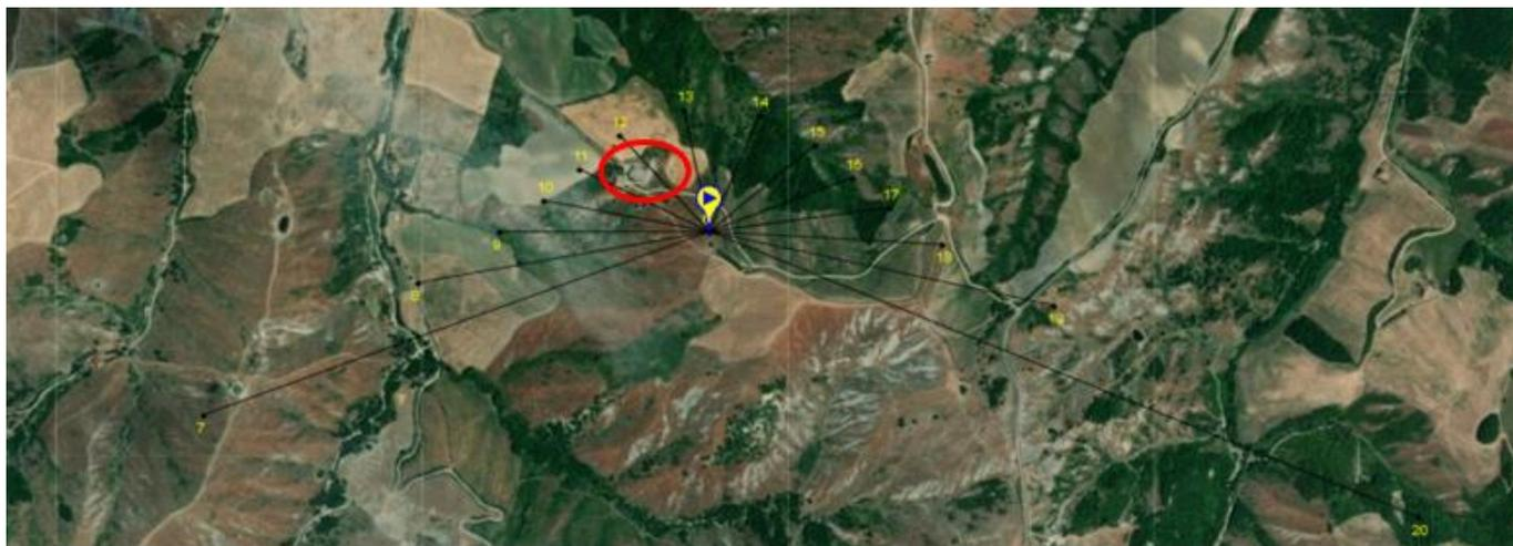
**Figura 123** Proiezione delle ombre del WTG9 in relazione alla presenza di un ricettore potenziale del disturbo
