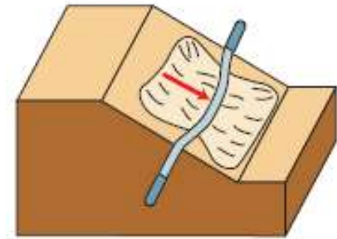
Fig. 12 - A sinistra il modello illustra l'interazione tra una frana ed una condotta disposta perpendicolarmente alla direzione di movimento della frana (Treccani). A destra: un oleodotto che si è spostato lateralmente di 9,5 m a causa di una frana.
