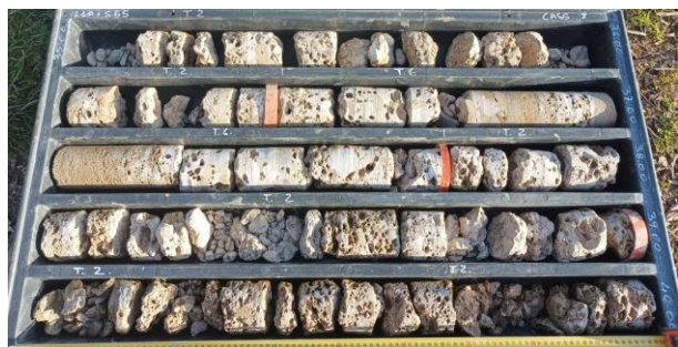
L 1-S 55: Casseta n. 8 da 35.0 a 40.0 m: Para/ortoconglomerati cementati, ad elementi poligenici generalmente arrotondati con prevalenti dimensioni di ghiaia media e grossa e sparsi ciottoli.
