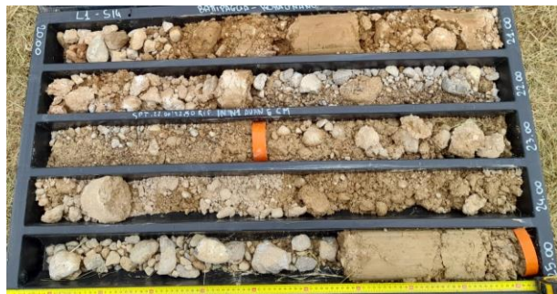
L 1-S 14: Casseta n. 5 da 20.0 a 25.0 m: Ghiaie sabbiose e sabbie con ghiaia deb. limose, a matrice avana, con alcune sottili intercalazioni a matrice limoso-sabbiosa marrone.
