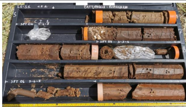
L 1-S 1: Casseta n. 2 da 5.0 a 10.0 m: Limo con argilla sabbioso, di colore da marrone chiaro a scuro, con dispersi scarsi inclusi litici di natura carbonatica. Struttura assente/omogenea; asciutto. Da molto a estremamente consistente, a consistenza crescente con la profondità.
