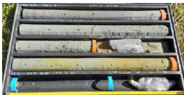
L 1-S 54: Cassetta n. 5 da 20.0 a 25.0 m: Argilla con limo debolmente sabbiosa, a tratti sabbiosa.
