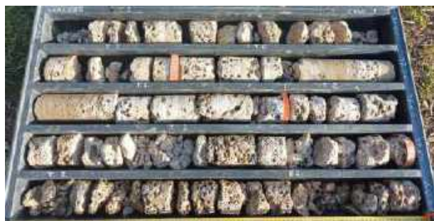
L 1-S 55: Cassetta n. 8 da 35.0 a 40.0 m: Para/ortoconglomerati cementati, ad elementi poligenici generalmente arrotondati con prevalenti dimensioni di ghiaia media e grossa e sparsi ciottoli.
