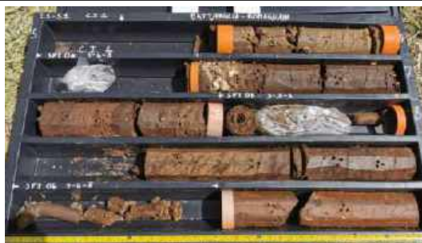
L 1-S 1: Cassetta n. 2 da 5.0 a 10.0 m: Limo con argilla sabbioso, di colore da marrone chiaro a scuro, con dispersi scarsi inclusi litici di natura carbonatica. Struttura assente/omogenea; asciutto. Da molto a estremamente consistente, a consistenza crescente con la profondità.
