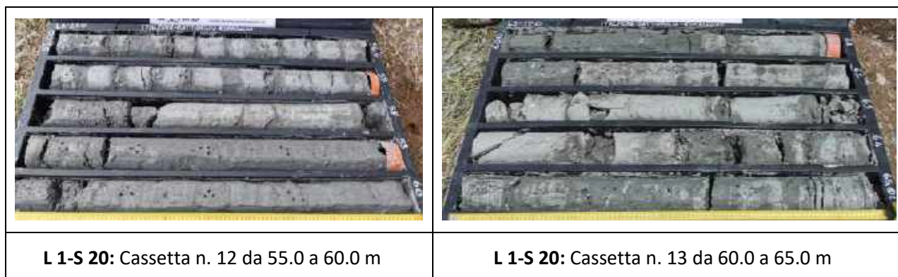
Figura 11-14: Foto rappresentative del materiale estratto dai sondaggi in SGH
