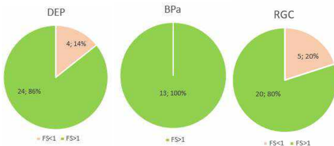
Figura 11-43: Sintesi risultati analisi liquefazione
