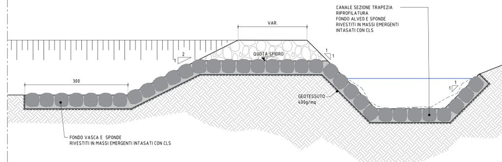
SEZIONE TIPO RESTITUZIONE CASSA DI ESPANSIONE
