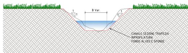
SEZIONE TIPO B - CANALE SEZIONE TRAPEZIA ARGINATO
