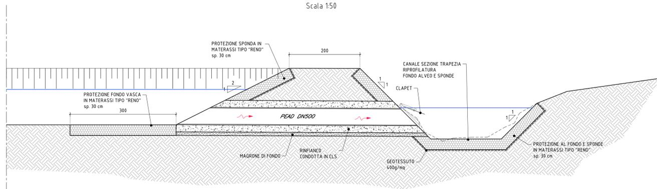
SEZIONE TIPO POSA TUBAZIONI DI SCARICO
