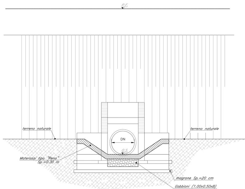
SEZIONE TIPO IMBOCCO SCATOLARE
