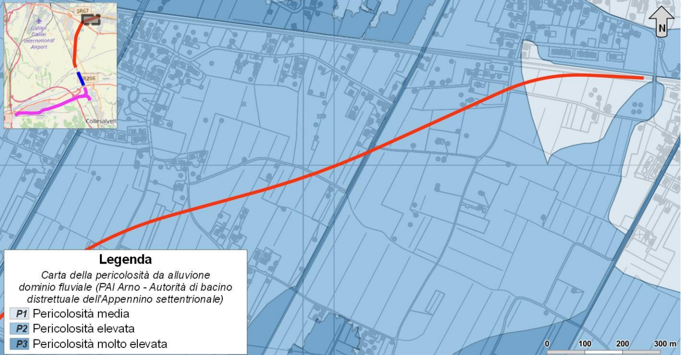
Figura 30 - Stralcio della carta della pericolosità da alluvione dominio fluviale (Autorità di Bacino distrettuale dell'Appennino Settentrionale) revisione 2019, con individuazione delle opere in progetto.
