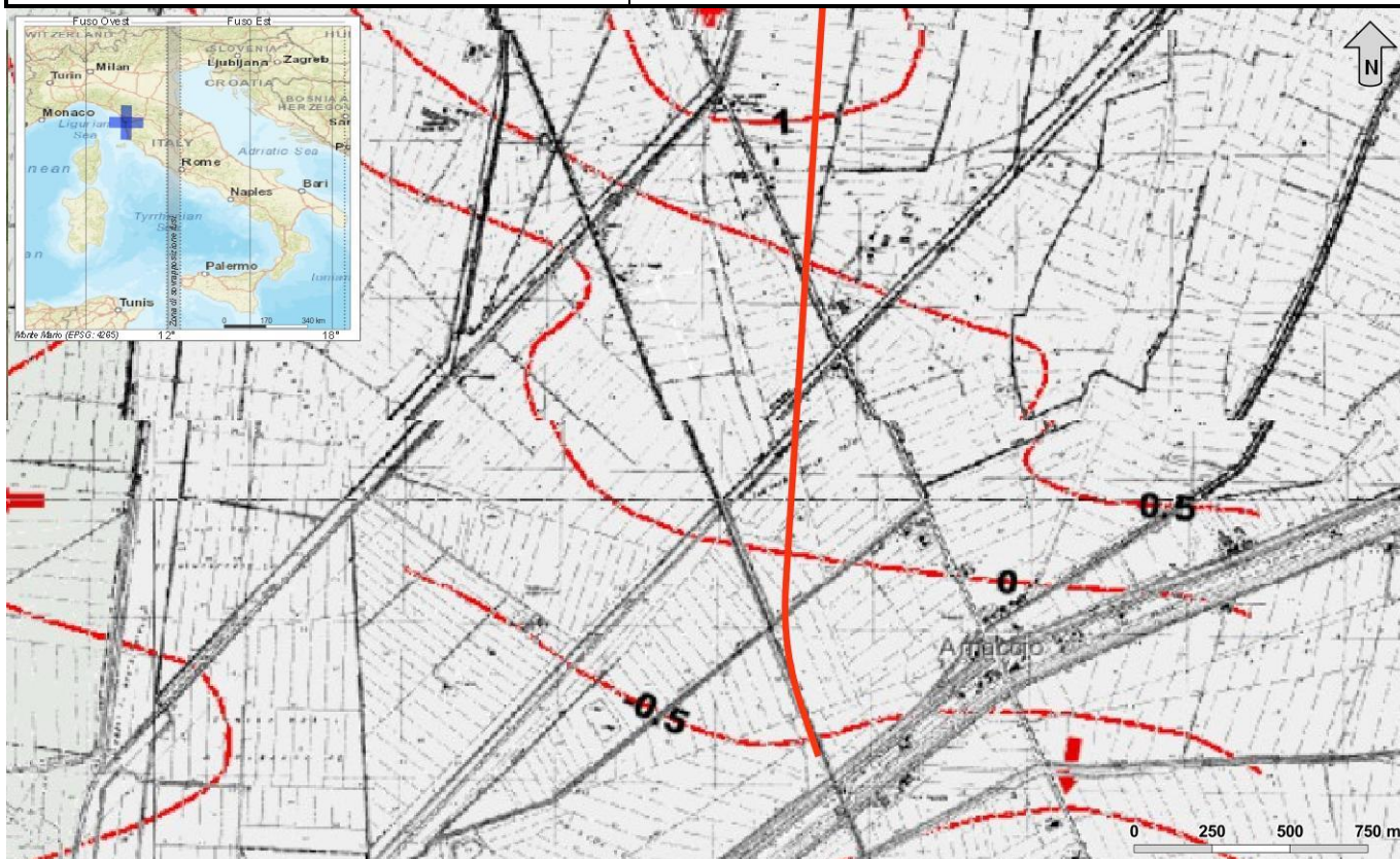
Figura 48 – Stralcio della carta b2.6 Carta idrogeologica del comune di Pisa ( https://www.comune.pisa.it/it/ufficio-scheda/21021/b2-6-Carta-idrogeologica.html ), con indicazione delle isopieze estive (m s.l.m.), delle linee di flusso e delle opere in progetto (Progetto del Bypass in colore rosso).
