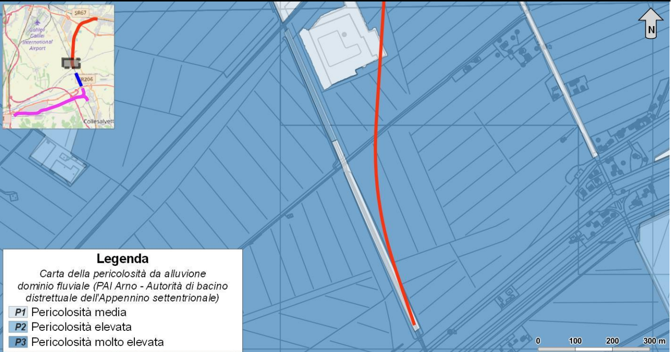
Figura 36 - Stralcio della carta della pericolosità da alluvione dominio fluviale (Autorità di Bacino distrettuale dell'Appennino Settentrionale) revisione 2019, con individuazione delle opere in progetto.
