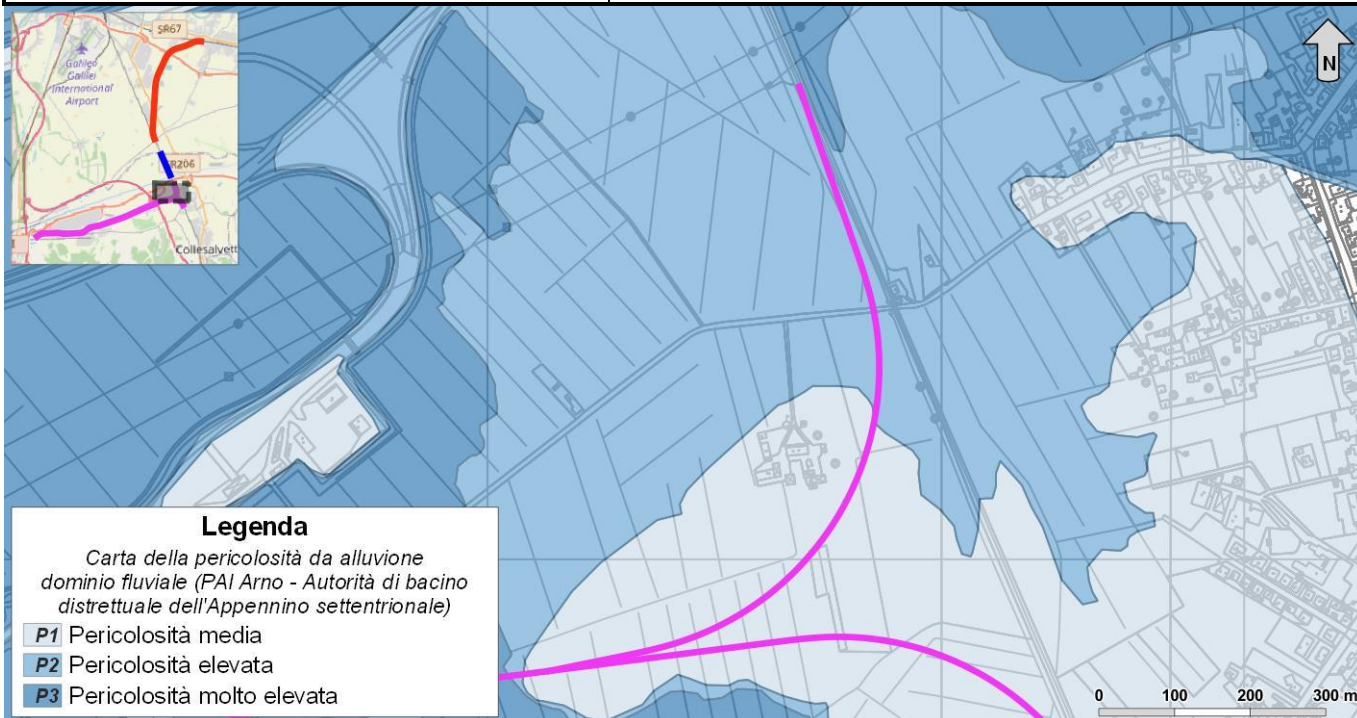
Figura 39 - Stralcio della carta della pericolosità da alluvione dominio fluviale (Autorità di Bacino distrettuale dell'Appennino Settentrionale) revisione 2019, con individuazione delle opere in progetto.
