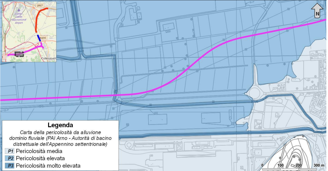
Figura 44 - Stralcio della carta della pericolosità da alluvione dominio fluviale (Autorità di Bacino distrettuale dell'Appennino Settentrionale) revisione 2019, con individuazione delle opere in progetto.
