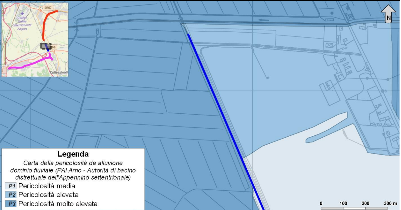
Figura 37 - Stralcio della carta della pericolosità da alluvione dominio fluviale (Autorità di Bacino distrettuale dell'Appennino Settentrionale) revisione 2019, con individuazione delle opere in progetto.
