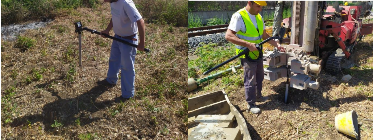
Figura 1: – Esecuzione di ricerca di masse metalliche superficiali e in foro mediante magnetometro MAGNEX della VOLTA.
