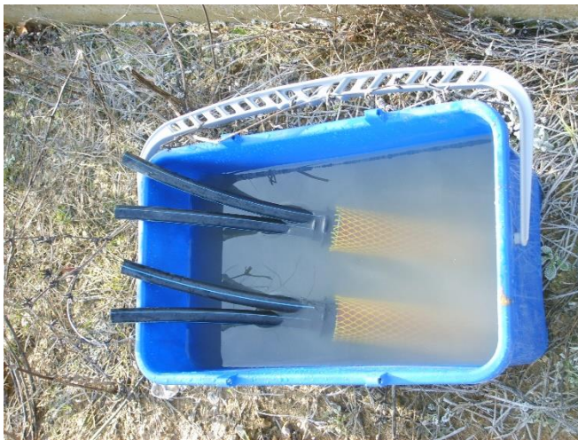
Figura 6: Fase di saturazione di celle di Casagrande
