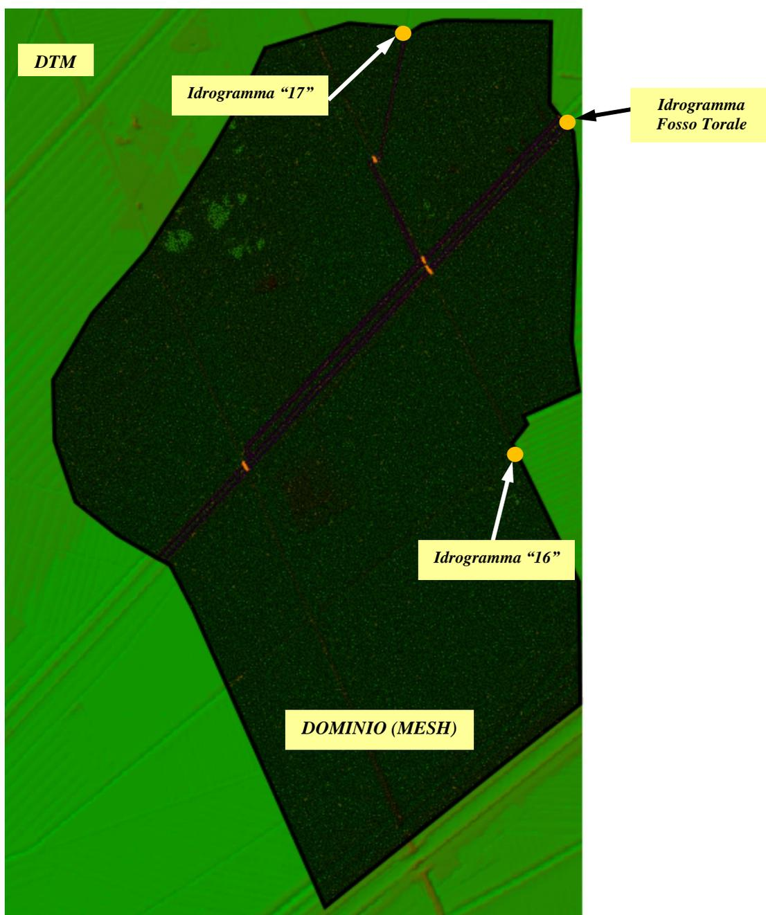
Fig. 8 – Modello numerico 2D del Fosso Torale: estensione del dominio di calcolo e condizioni al contorno.
