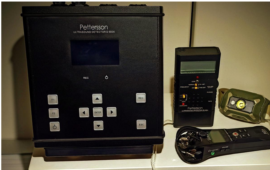
Figura 4 - Attrezzatura utilizzata per il monitoraggio dei chiroteri. Da destra verso sinistra: Bat detector D 500X per la registrazione prolungata in campo degli ultrasuoni. Rilevatore a eterodina ed espansione temporale (x10 e x20 selezionabile). Registratore multitraccia collegato al D 240X.
