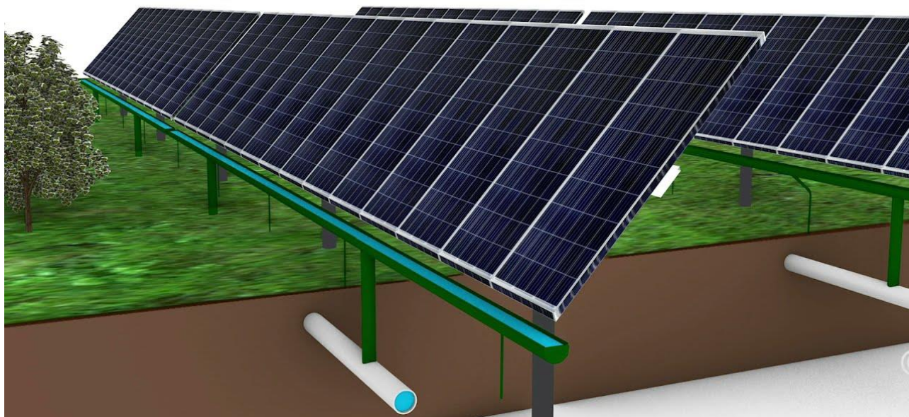
Figura 13 - Sistema per l'accumulo di acqua piovana in un impianto agrivoltaico (fonte: Rain Water Recovery)
