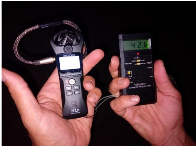
Figura 5- Preparazione del Bat Detector Pettersson D500 x per i rilievi su postazione fissa prolungata e D240 per i punti ascolto.
