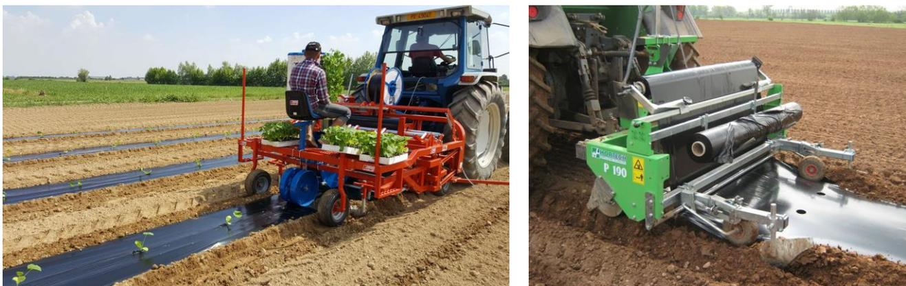
**Fig. 7/3: Posizionamento del telo pacciamante**
