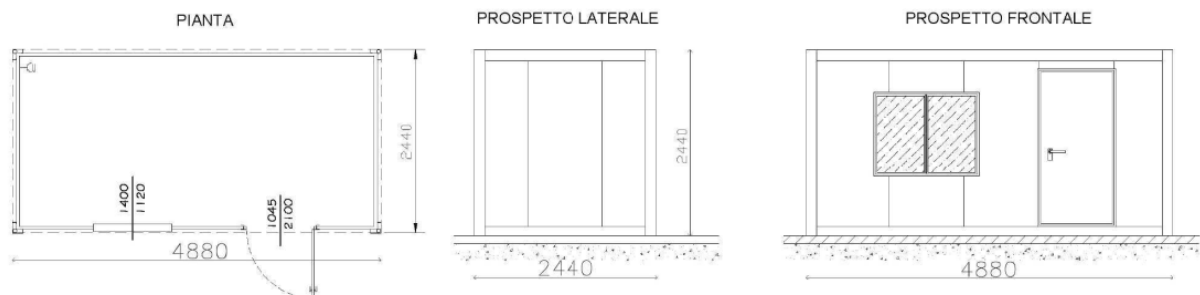
Figura 30 - Pianta e prospetti tipo del locale tecnico
