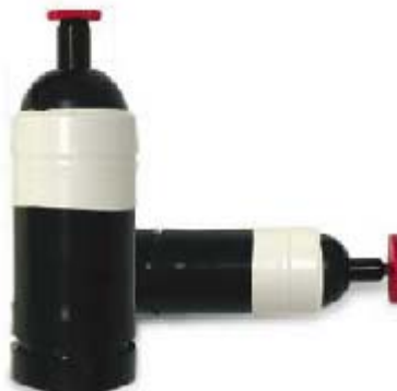
Immagine 3: supporto per metodologia SEM - membrane in cassette precaricate policarbonato 0,8 u 25 mm
