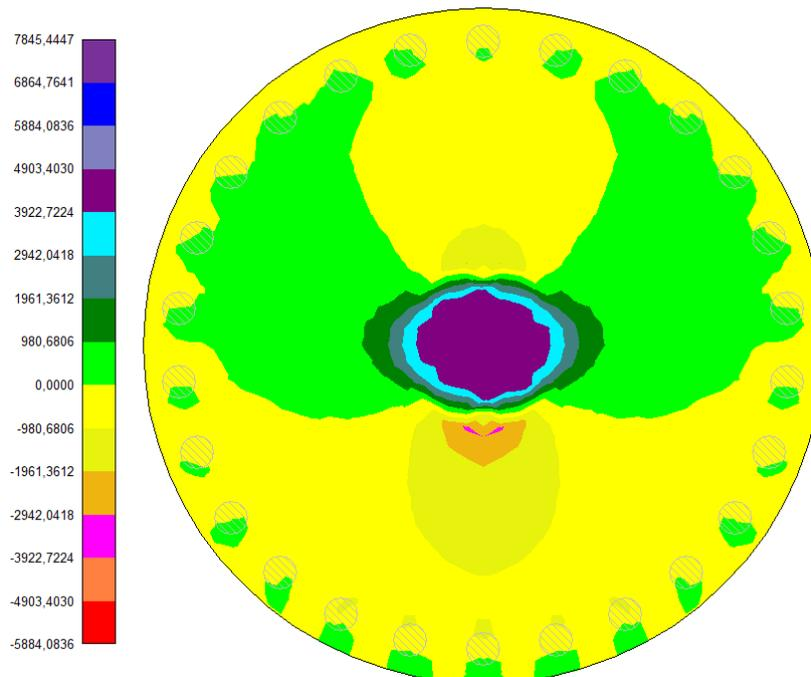
Dall'analisi delle colormap possiamo affermare che, nella configurazione di carico analizzata, le sollecitazioni massime agenti lungo la struttura esaminata sono localizzate lungo il diametro della fondazione individuato dall'asse Y. Pertanto si è concentrata l'analisi sulle sollecitazioni radiali e tangenziali agenti lungo tale asse, al fine di estendere i risultati dell'analisi alla totalità della fondazione.
