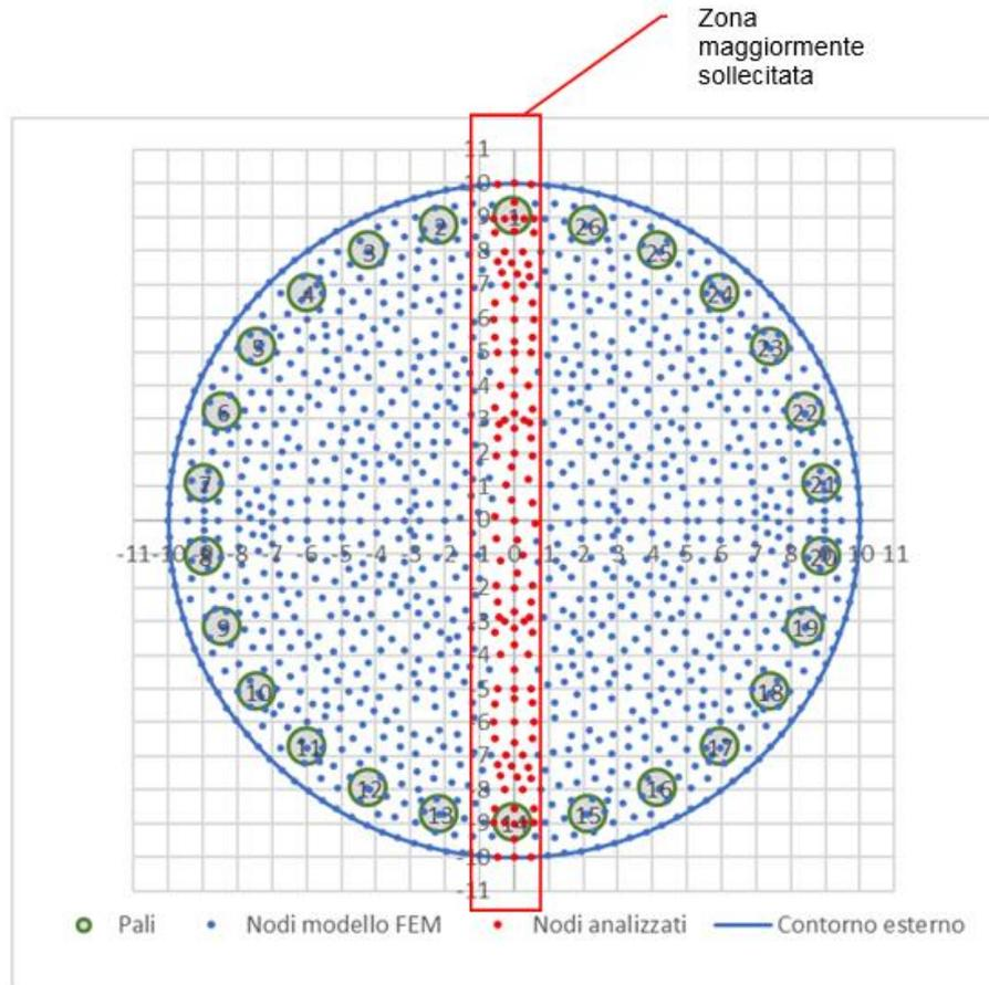
Per la definizione delle azioni massime agenti è stato effettuato l'involuppo delle sollecitazioni nodali agenti nei punti individuati in figura come nodi analizzati, appartenenti ad una fascia di fondazione di larghezza pari ad 1,2 m a cavallo dell'asse Y.
