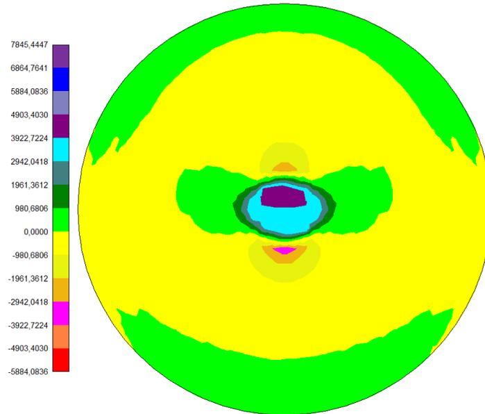
Dall'analisi delle colormap possiamo affermare che, nella configurazione di carico analizzata, le sollecitazioni massime agenti lungo la struttura esaminata sono localizzate lungo il diametro della fondazione individuato dall'asse Y. Pertanto si è concentrata l'analisi sulle sollecitazioni radiali e tangenziali agenti lungo tale asse, al fine di estendere i risultati dell'analisi alla totalità della fondazione.
