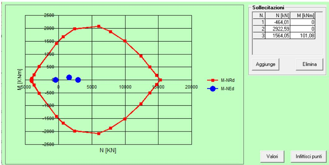
I punti individuati sono tutti interni al dominio di rottura della sezione, pertanto la sezione risulta verificata.
