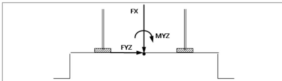
Figura 6 - Sistema di coordinate per le sollecitazioni al nodo torre-pilota
