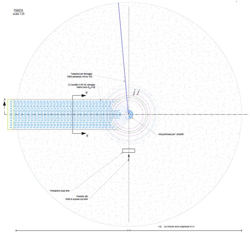
Figura 1 - Pianta del plinto diretto
