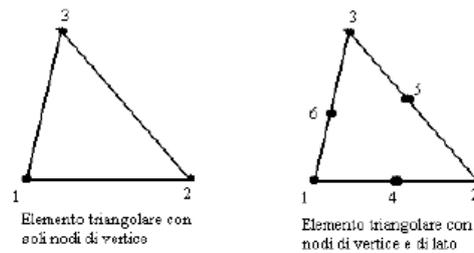
Il programma utilizza, per l'analisi tipo piastra, elementi quadrangolari e triangolari.
