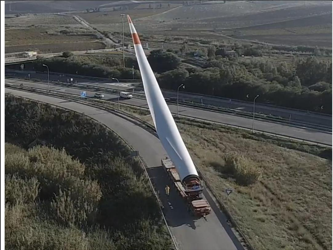
*Figura 3.39 - Immagine 2 - Blade lifter in azione*
