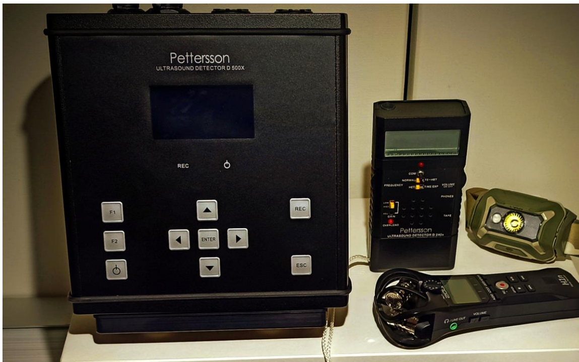
Foto n. 1: Attrezzatura utilizzata per il monitoraggio dei chirotteri. Da destra verso sinistra: Rilevatore a eterodina ed espansione temporale (x10 e x20 selezionabile). Bat detector D 500X per la registrazione prolungata in campo degli ultrasuoni . Registratore multitraccia collegato al D 240X.
