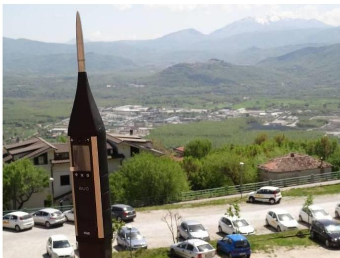
**Figura 4-1: Analizzatore in frequenza DUO**
