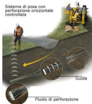
L'esecuzione della trivellazione orizzontale controllata (T.O.C.) consta essenzialmente di due fasi di lavoro:
