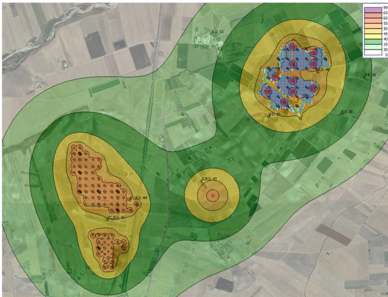
Figura 18 - Mappa di propagazione del rumore IMPATTI CUMULATIVI (PERIODO DIURNO) con indicazione dei ricettori ICR1 - ICR2 - ICR3
