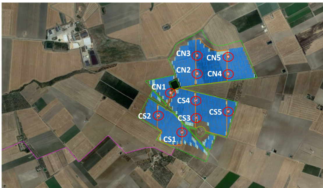
Figura 7 - Ubicazione delle cabine di campo (POWER SKID) indicate con i simboli CN# per il Campo Nord e CS# per il Campo Sud
