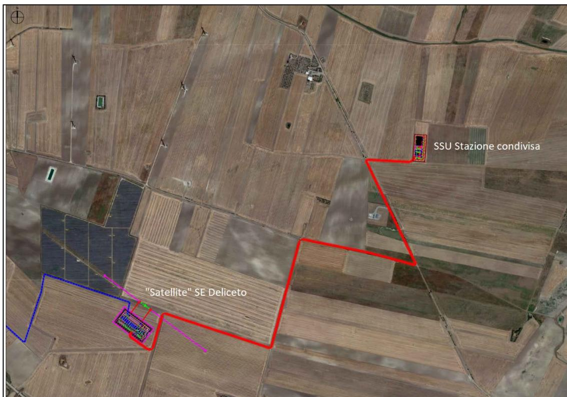
Infine, come opere RTN sarà prevista, come da STMG di Terna SpA, la realizzazione dell'ampliamento ("Satellite") della attuale SE TERNA DELICETO. Le due Stazioni Elettriche saranno collegate da un cavo AT da 150kV interrato lungo circa 1,75 km (cfr. figura seguente).
