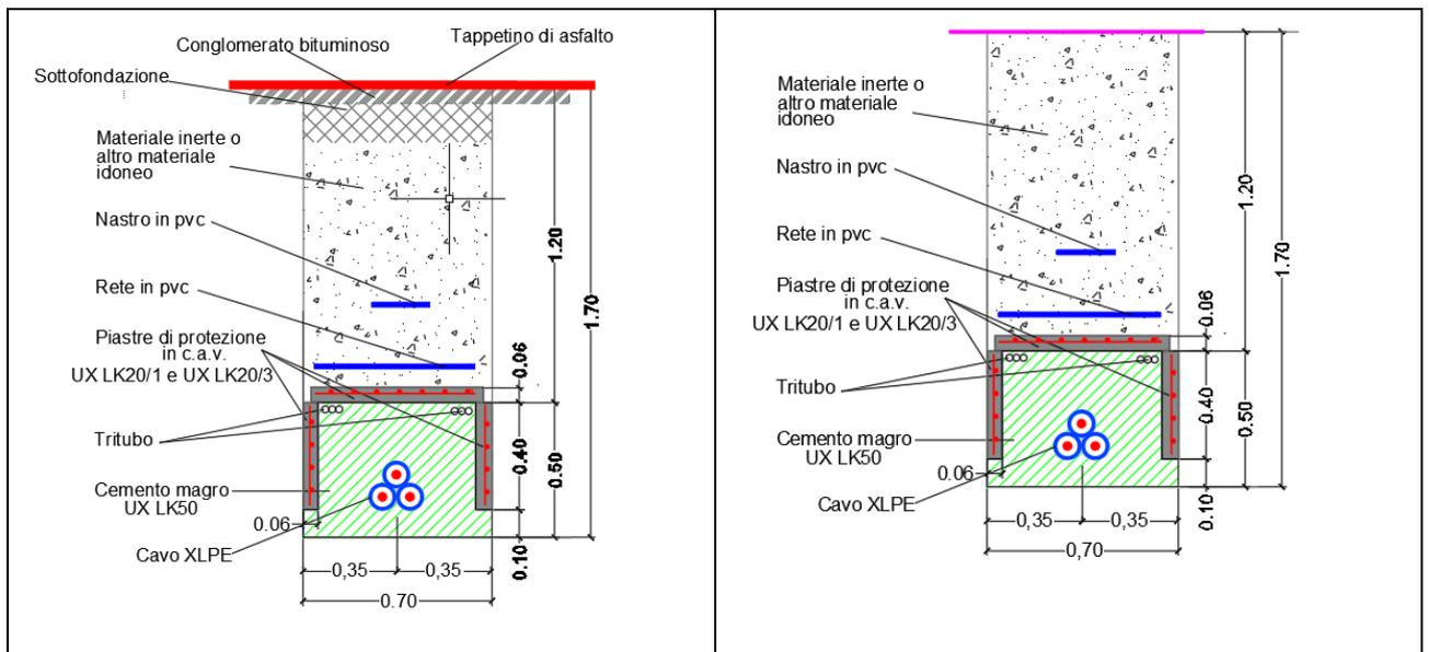
**Figura 1: A sinistra tipologico di posa scavo 150 kV su strada asfaltata, a destra tipologico di posa su terreno o strada sterrata**
