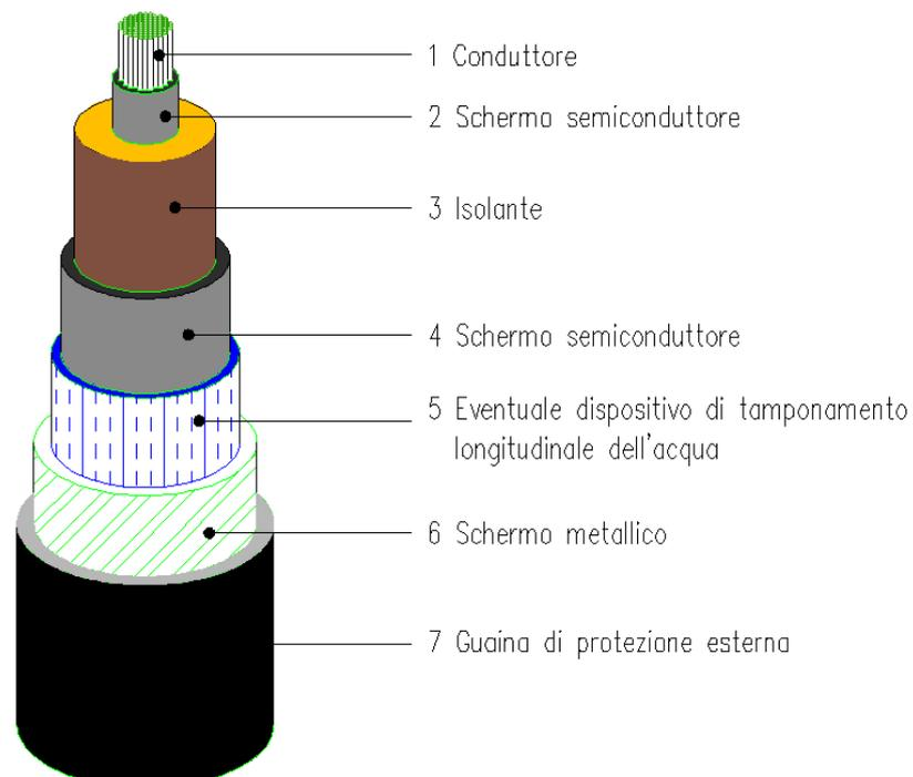
**DATI TECNICI DEL CAVO****Cavo 150 kV sezione 1600 mm<sup>2</sup> in alluminio****CARATTERISTICHE DIMENSIONALI**
