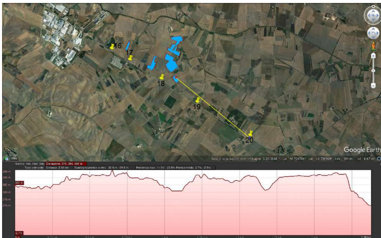
Figura 102. Profilo del terreno dal P20 all’area di impianto.
