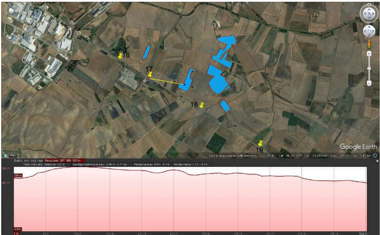
Figura 90. Profilo del terreno dal P17 all'area di impianto.
