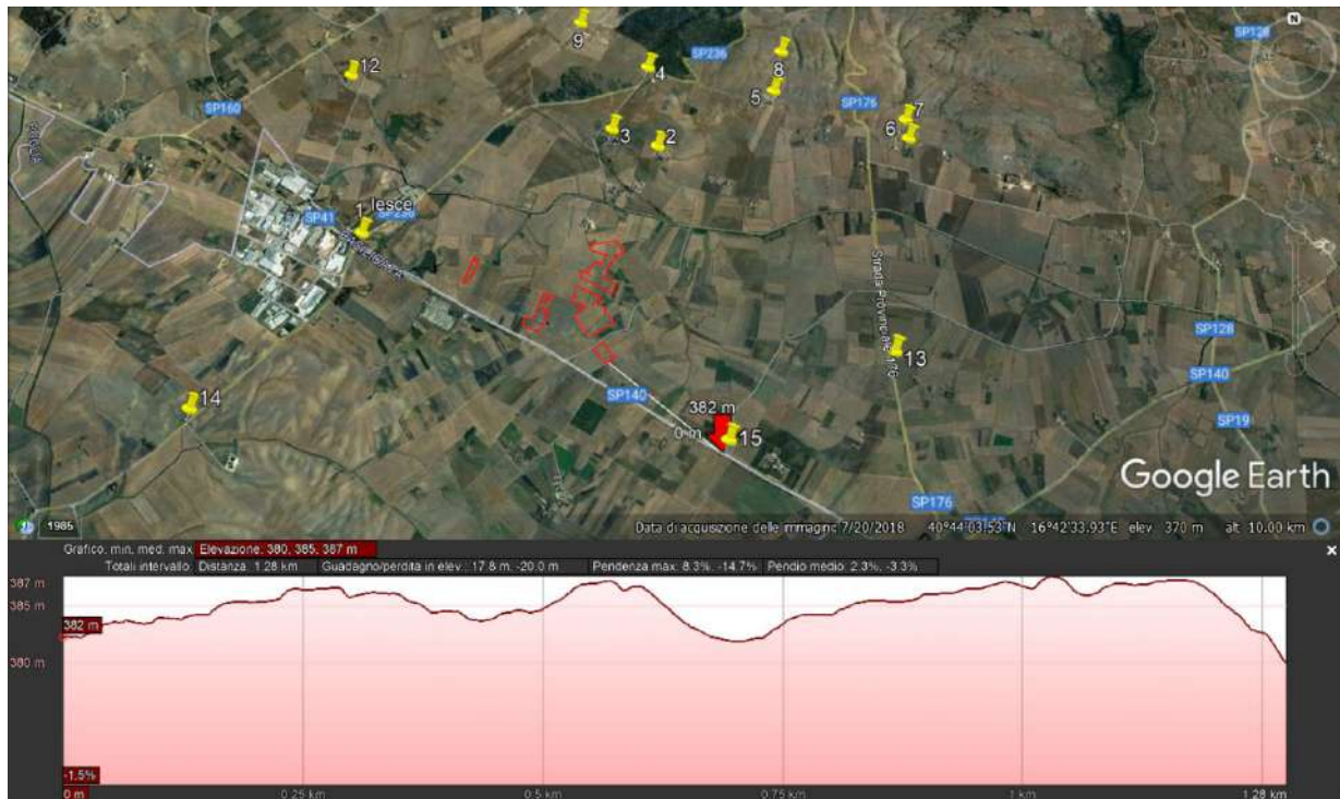
Figura 81. – Profilo del terreno dal P15 all’area di impianto.
