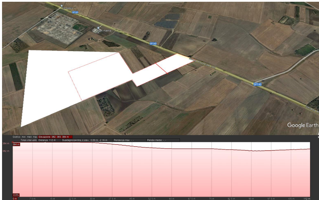
Figura 10 - PROFILO LONGITUDINALE STRADA DI ACCESSO
