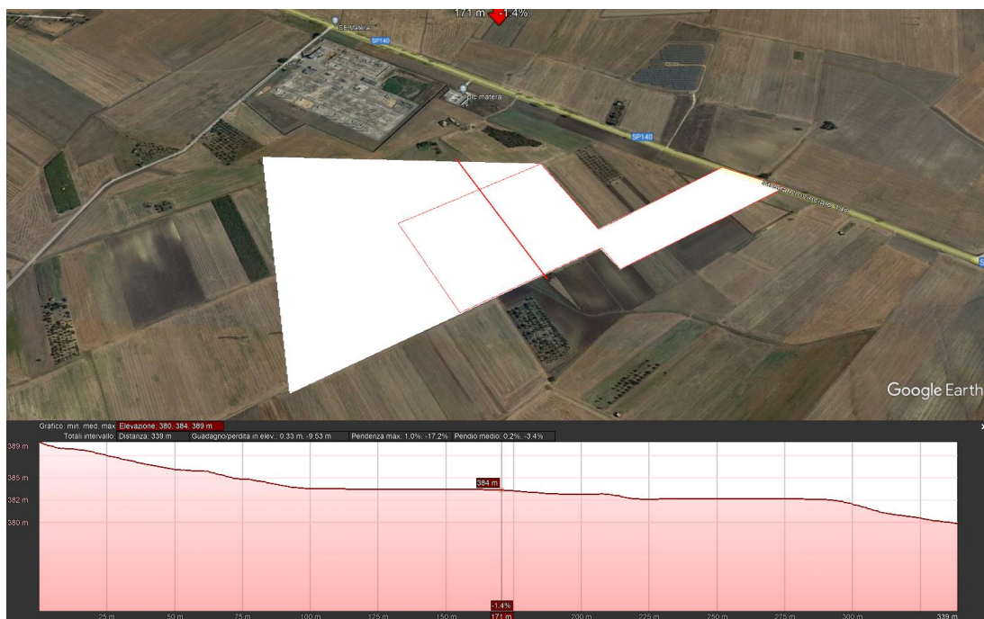
Figura 9 - PROFILO LONGITUDINALE AREA DI STAZIONE
