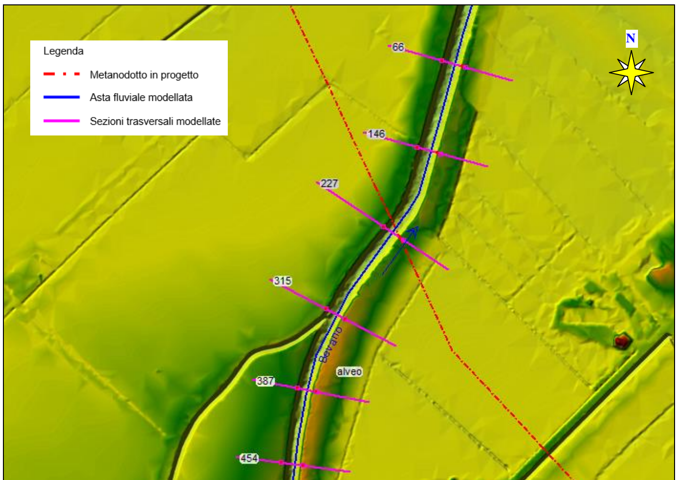
Fig.5.2/A: Schermata del DTM, con tronco d'alveo analizzato e sezioni di input nella modellazione
