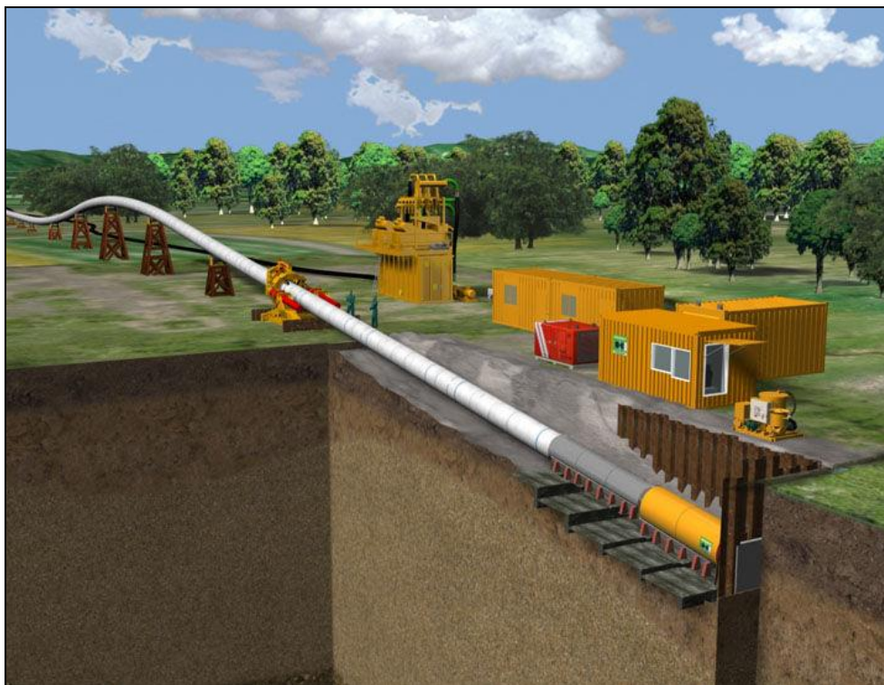
Fig.7.3/A: Schema illustrativo della postazione di trivellazione all'inizio della perforazione [Herrenknecht AG]
