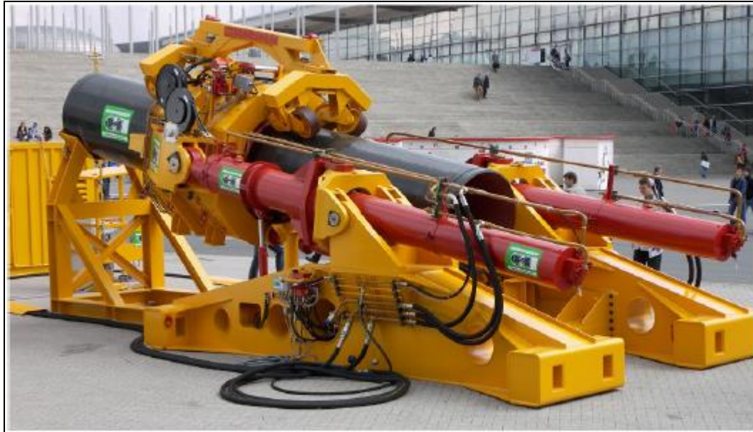
Fig.7.3/D: Pipe Thruster, presentata Hannover nel 2006 [Herrenknecht]
