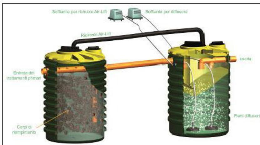
Il filtro percolatore è un reattore biologico nel quale i microrganismi, in condizioni anaerobiche, usano la sostanza biodegradabile contenuta nel refluo. Questi si sviluppano sulla superficie di appositi corpi di riempimento in polipropilene disposti alla rinfusa, pensati proprio per rendere massima la superficie di contatto tra i microrganismi e il refluo. L'impianto a fanghi attivi è un sistema nel quale la flora batterica si sviluppa in colonie che
