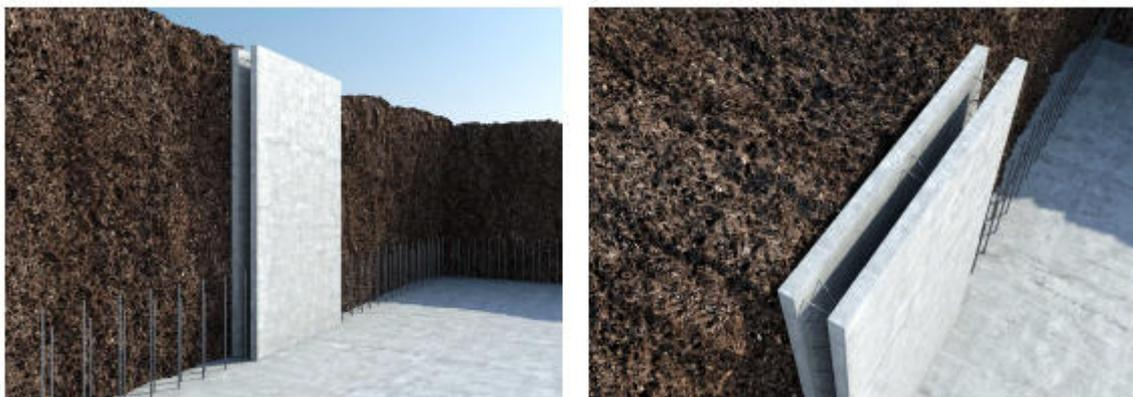
*Figura 4.8 – Esempio tipologico di muro prefabbricato in C.A.*
