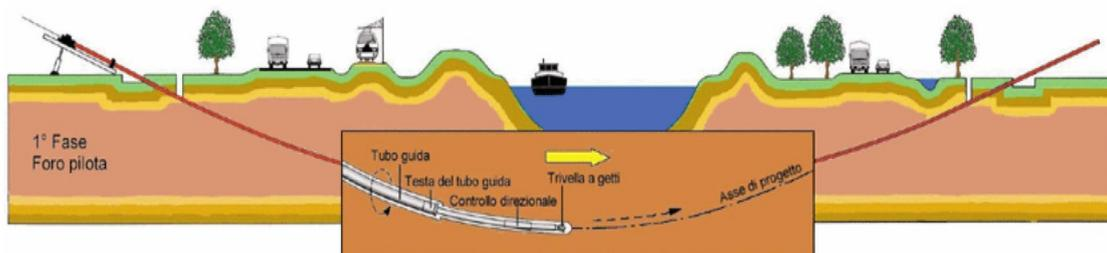
**Figure 11 – Schema della fase di realizzazione del foro pilota.**
