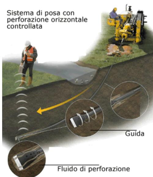
**Figure 10-Sistema di trivellazione orizzontale controllata (T.O.C.).**
