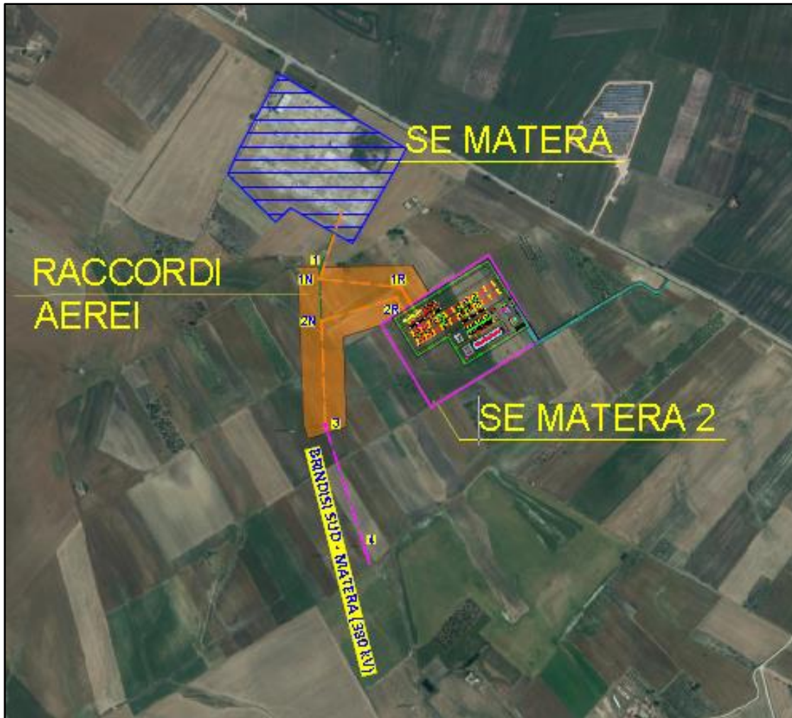
Figura 1 – ORTOFOTO CON STAZIONE, SOTTOSTAZIONE E CAVIDOTTO AT
