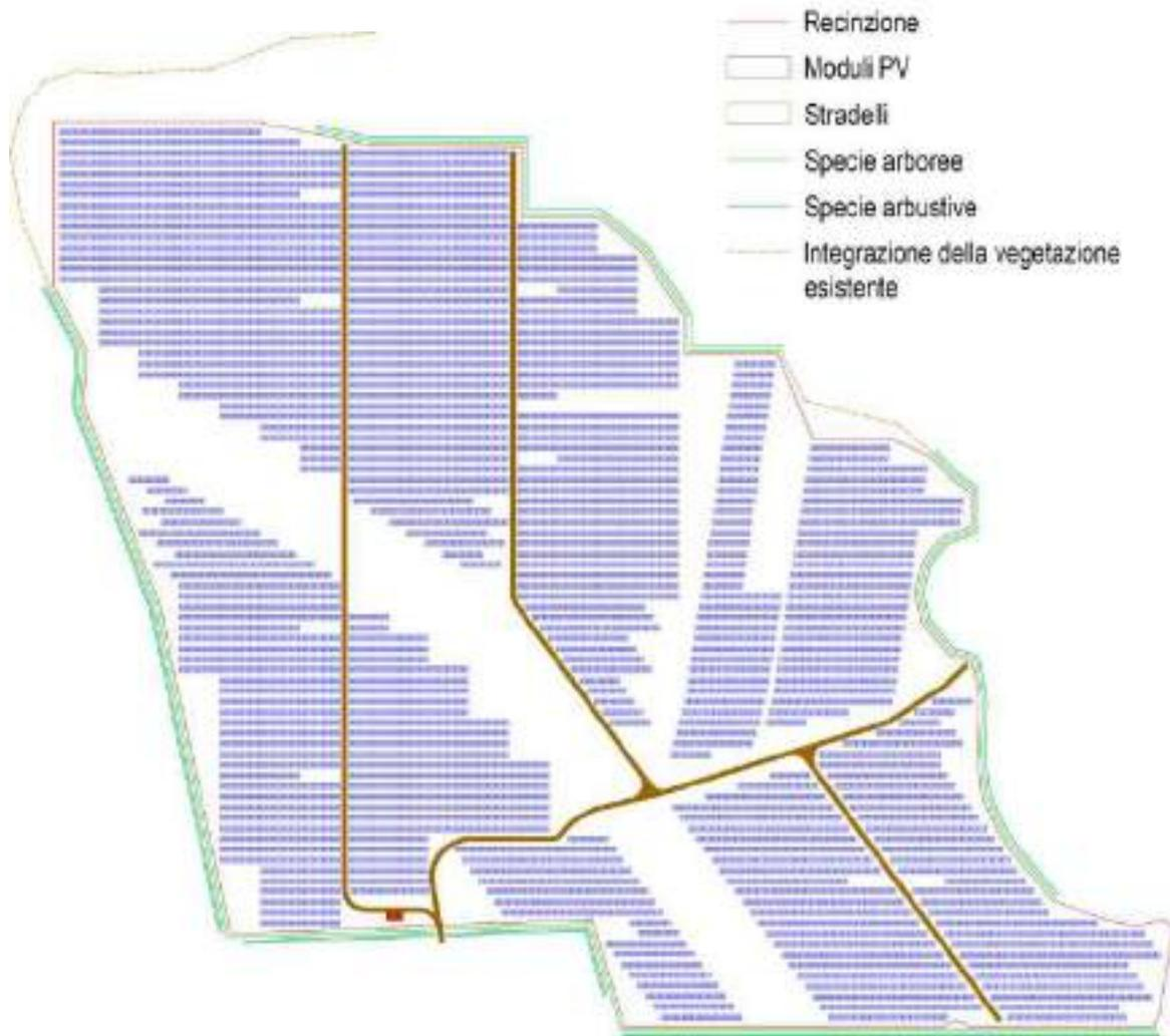
**Figura 8: Layout dell'impianto con la posizione delle tipologie di mitigazione.**
