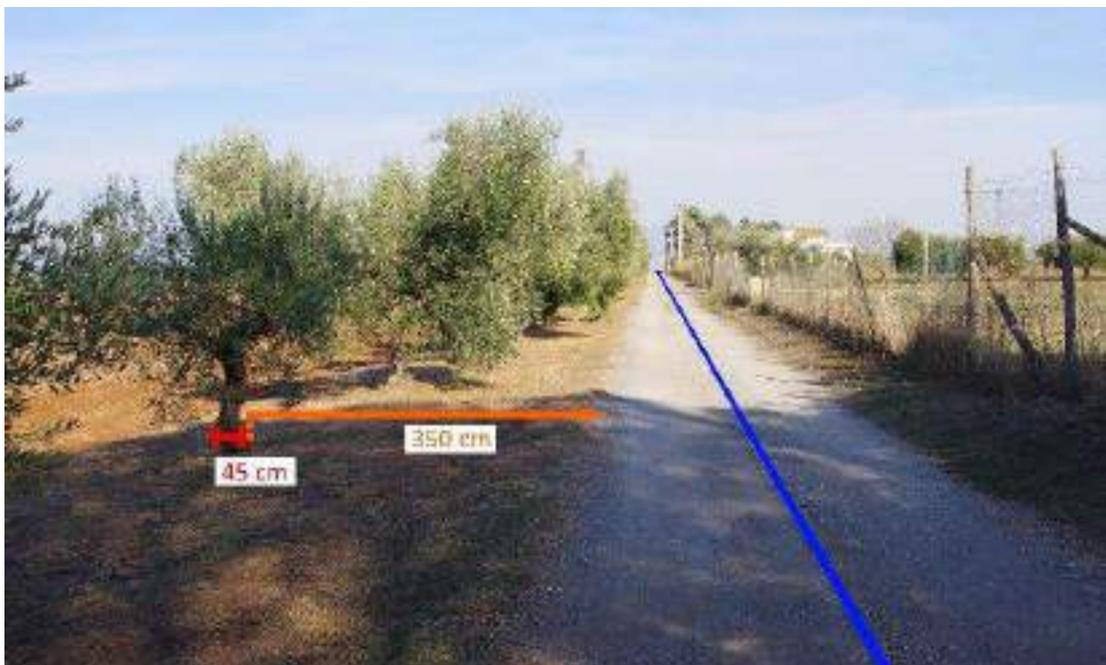
**Figura 5: Distanza tra il filare di ulivi e la strada interessata dall'installazione del cavidotto (in blu).**
