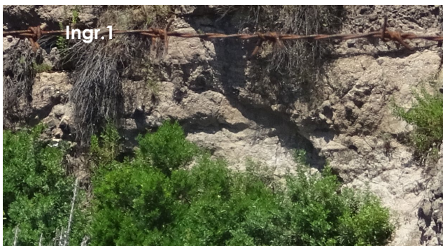
Figura 3-5: osservazione dei primi metri da p.c. delle litologie andesitiche-basaltiche. In alto quadro generale, a) primo ingrandimento con intercalazioni debolmente stratificate, b) stato di cementazione matrice lapidea
