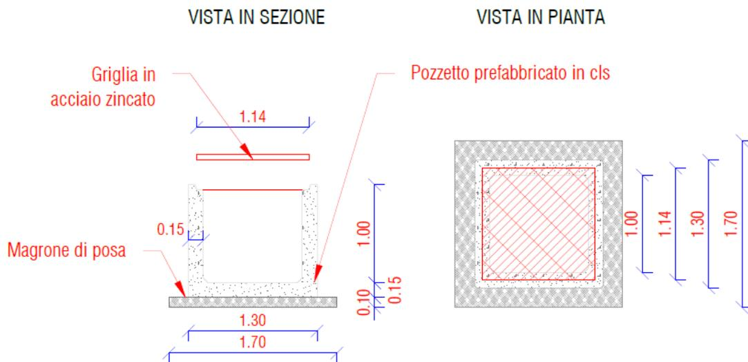
**Figura 6-7 Particolare Pozzetto in calcestruzzo attraversamento**
