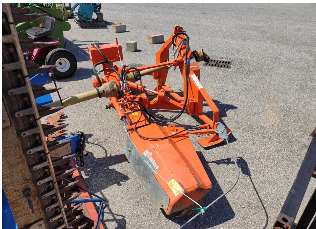
Figura 20 - Fresatrice interceppo. In primo piano il dispositivo che fa evitare all'attrezzo di urtare i sostegni delle stringhe
