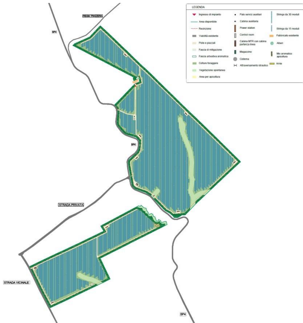
Figura 11 - Layout generale di impianto su ortofoto
