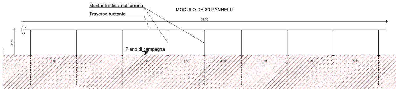
Questa rotazione permette ai pannelli fotovoltaici di rivolgersi ai raggi solari con un angolo di variabilità del piano dei pannelli che va da  $+55^\circ$  a  $-55^\circ$  rispetto all'orizzontale.
