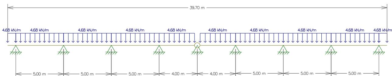
Ovvero, in base alle reazioni orizzontali e verticali sopra riportate si ha lo schema di carico della figura a fianco.
