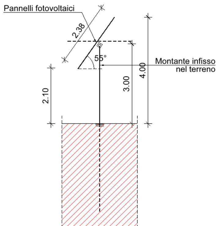
La stringa da 15 moduli ha una lunghezza totale di 19.90 m con n. 5 montanti infissi nel terreno a passo di 5.00 m (un solo passo è pari a 4.00 m), con singolo pannello da 2.38 m di lunghezza.
