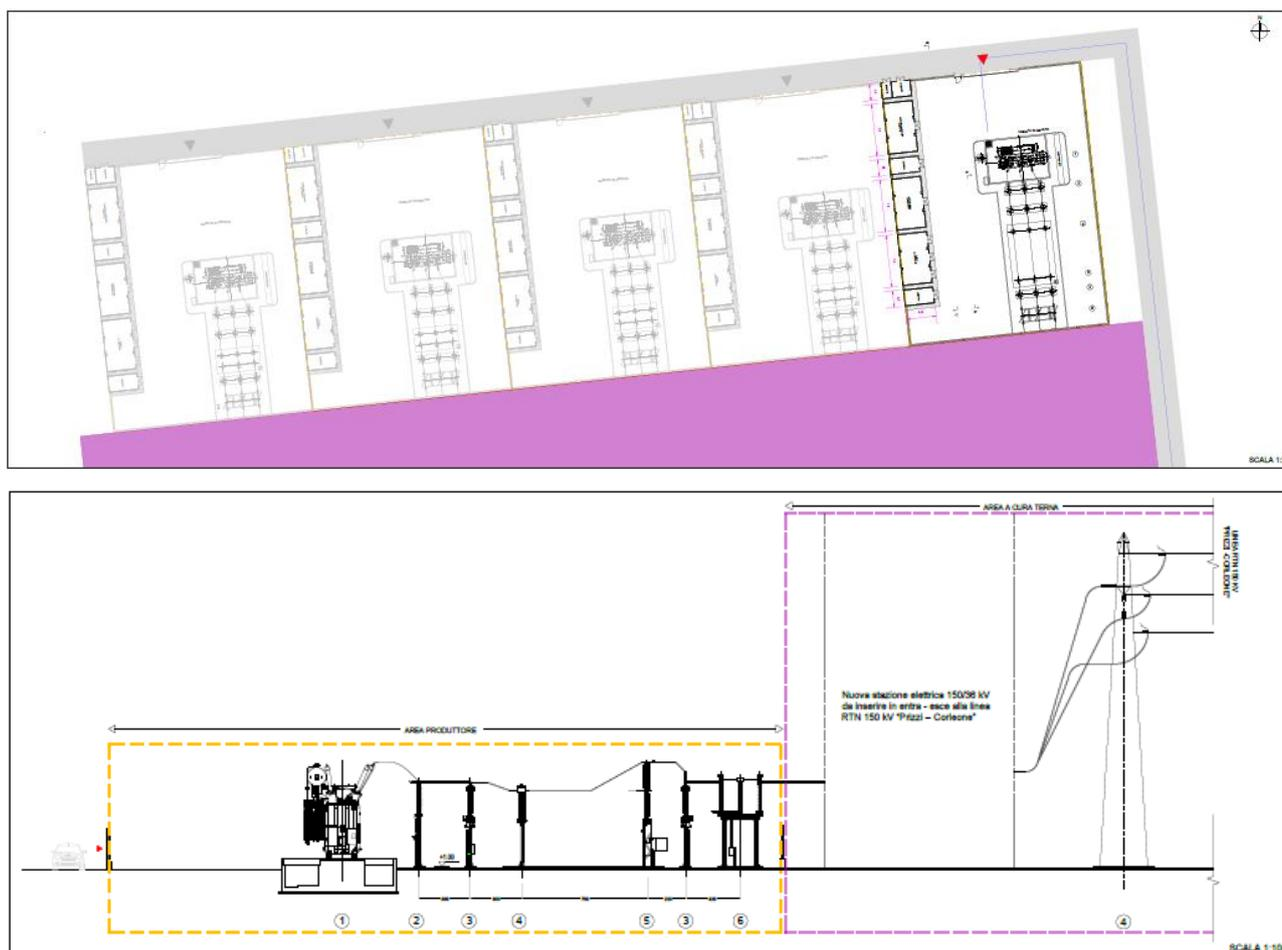
Figura 2 Planimetria SSE con particolare ubicazione macchina elettrica
