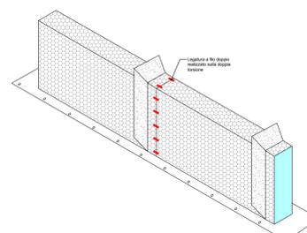
FASE 3 - RISVOLTO DELLE FASCETTE PROTETTIVE IN GEOTESSILE E ANCORAGGIO DELLA GUAINA IMPERMEABILE OCCHIELLATA ALLA BASE DEI PANNELLI DRENANTI
