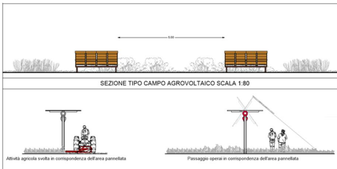
Figura 15 - Sezione tipo del campo agrovoltaiico a foraggiere
