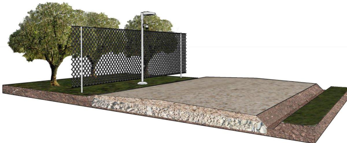
Figura 18 Vista prospettica tipo della fascia perimetrale dell'impianto
