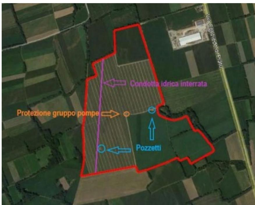
**Figura 5** – Interferenze censite all'interno dell'area di progetto
