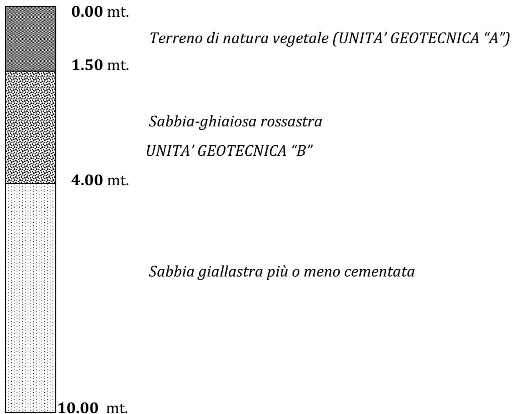
Per il dimensionamento delle opere fondali delle strutture previste in progetto si effettueranno, in fase esecutiva, apposite indagini in sito, si riportano in maniera soltanto indicativa i parametri geotecnici e sismici ottenuti attraverso l'utilizzo di dati rivenienti sia dalla bibliografia geologica e sia da indagini effettuate dallo scrivente su terreni assimilabili da un punto di vista geomeccanico.
