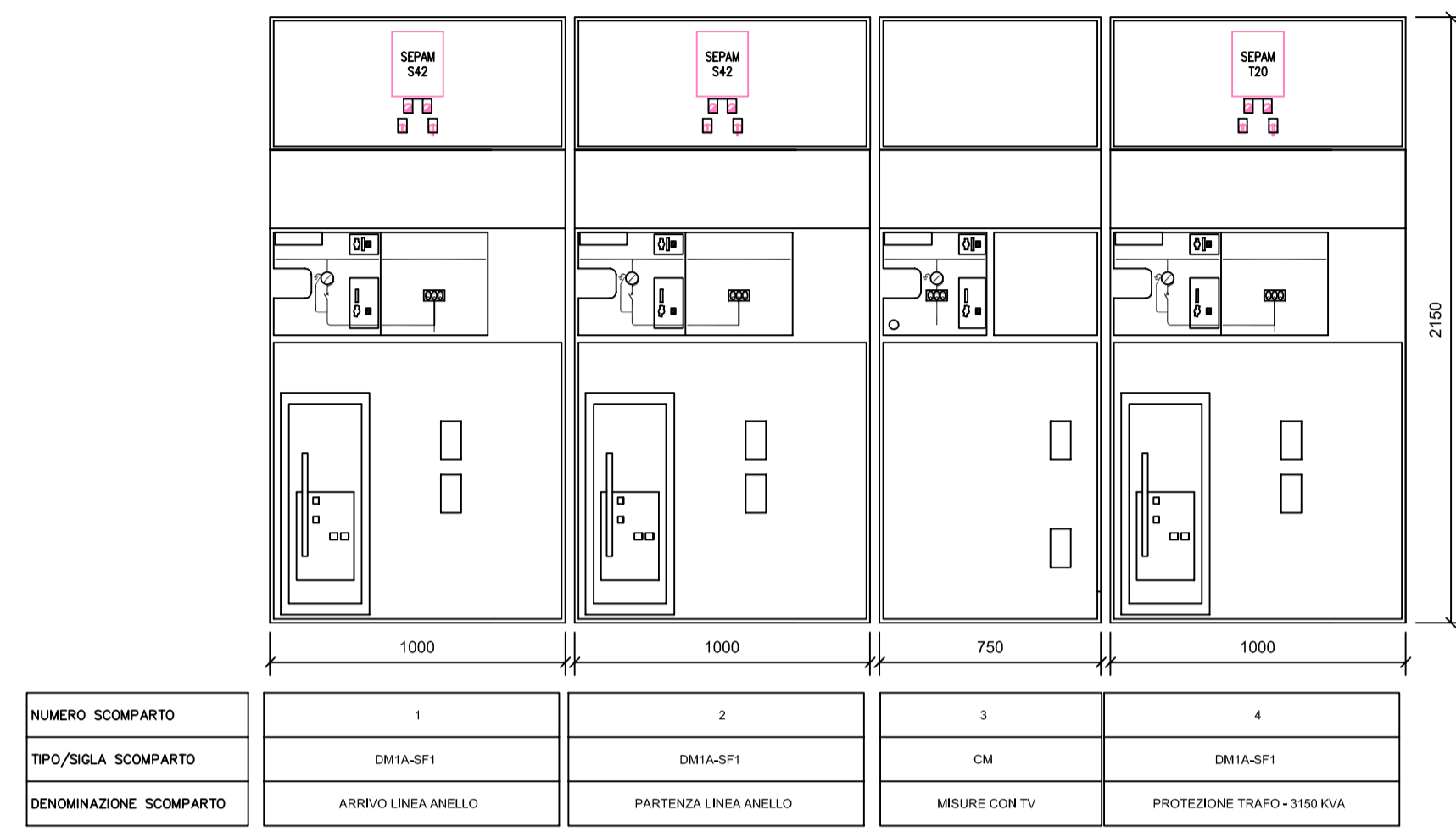
VISTA FRONTALE TIPICO QMT - 30kV DI CAMPO
