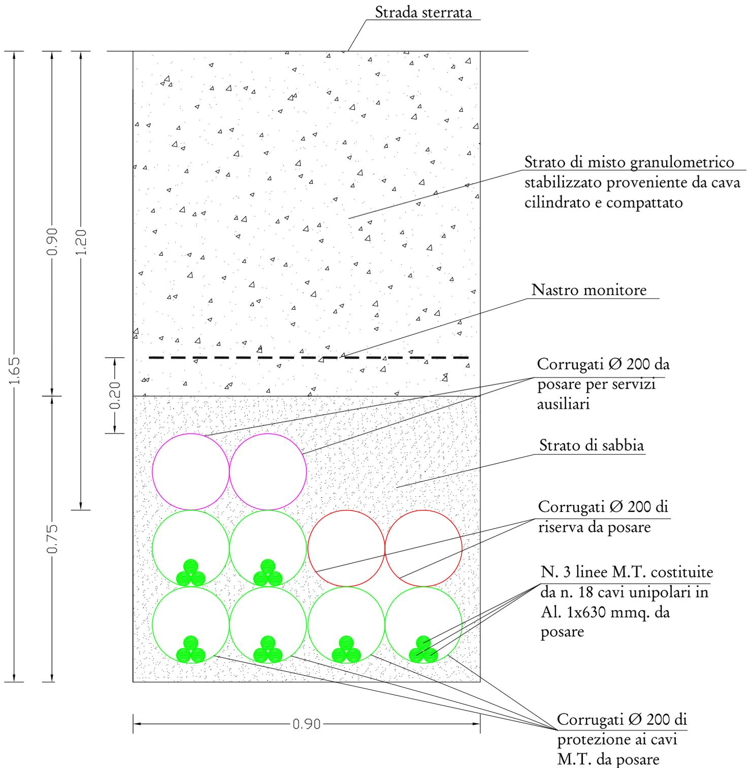
PARTICOLARE SCAVO E RIPRISTINO DA EFFETTUARE PER LA POSA DI N. 10 TUBI SPESSORATI FLESSIBILI Ø 200 DI CUI N. 2 DI PREDISPOSIZIONE, N. 6 DI PROTEZIONE AI CAVI M.T. E N. 2 PER I SERVIZI AUSILIARI DA EFFETTUARE ALL'INTERNO DI UNO SCAVO A TRINCEA A SEZIONE RISTRETTA IN SENSO TRASVERSALE E/O PARALLELO SU STRADE BITUMATE
