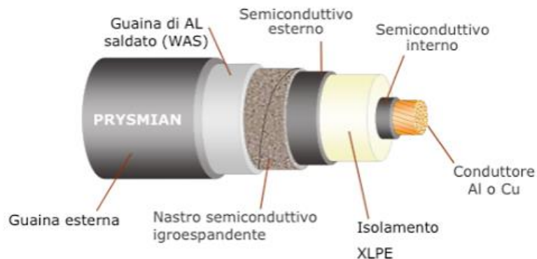
Figura 15: Componenti cavidotto AT
