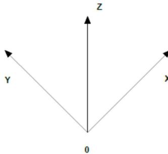
Il sistema di riferimento globale, rispetto al quale va riferita l'intera struttura, è costituito da una terna di assi cartesiani sinistrorsa OXYZ (X, Y, Z posizionati a  $90^\circ$  tra loro).
