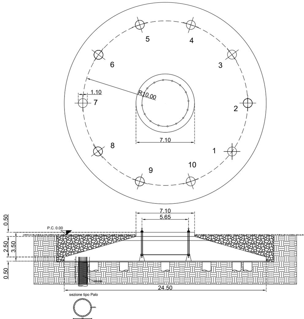
**Figura 5.1.1:** Dettaglio pianta e sezione fondazione
