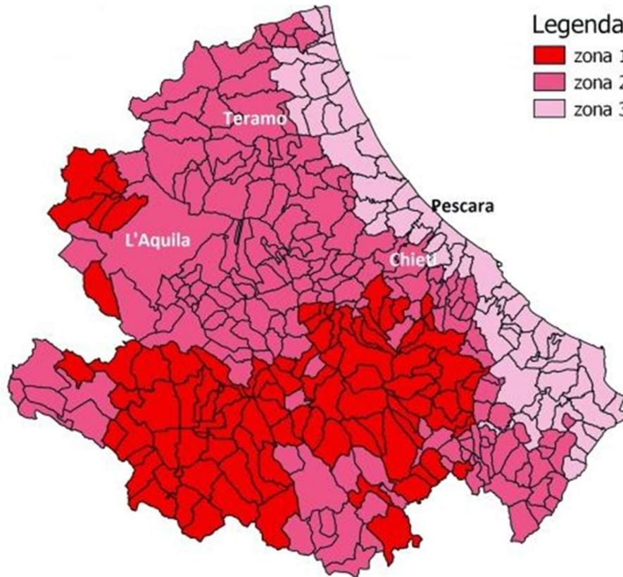
Lo studio di pericolosità sismica, adottato con l'**O.P.C.M. del 28 aprile 2006 n. 3519**, attribuisce alle 4 zone sismiche degli intervalli di accelerazione orizzontale del suolo ( $a_g$ ), con probabilità di superamento pari al 10% in 50 anni. *Nel caso in esame l'accelerazione orizzontale del suolo ( $a_g$ ) risulta essere:*
