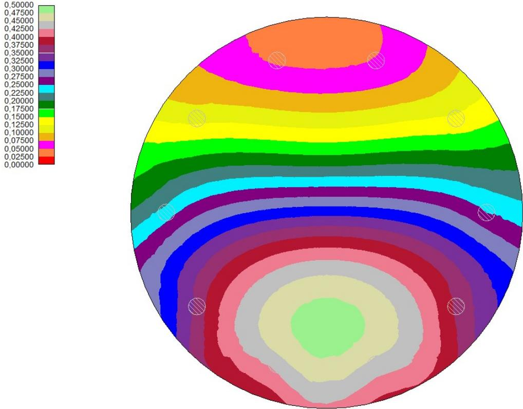
Figura 10.1.1 – Diagramma dei cedimenti (unità di misura cm)
