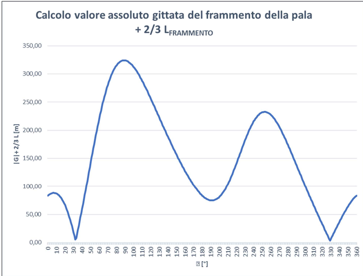
Figura 8.2: Grafico del valore assoluto della gittata del frammento della pala di lunghezza 5 \text{ m} + \frac{2}{3} L_{\text{FRAMMENTO}}
