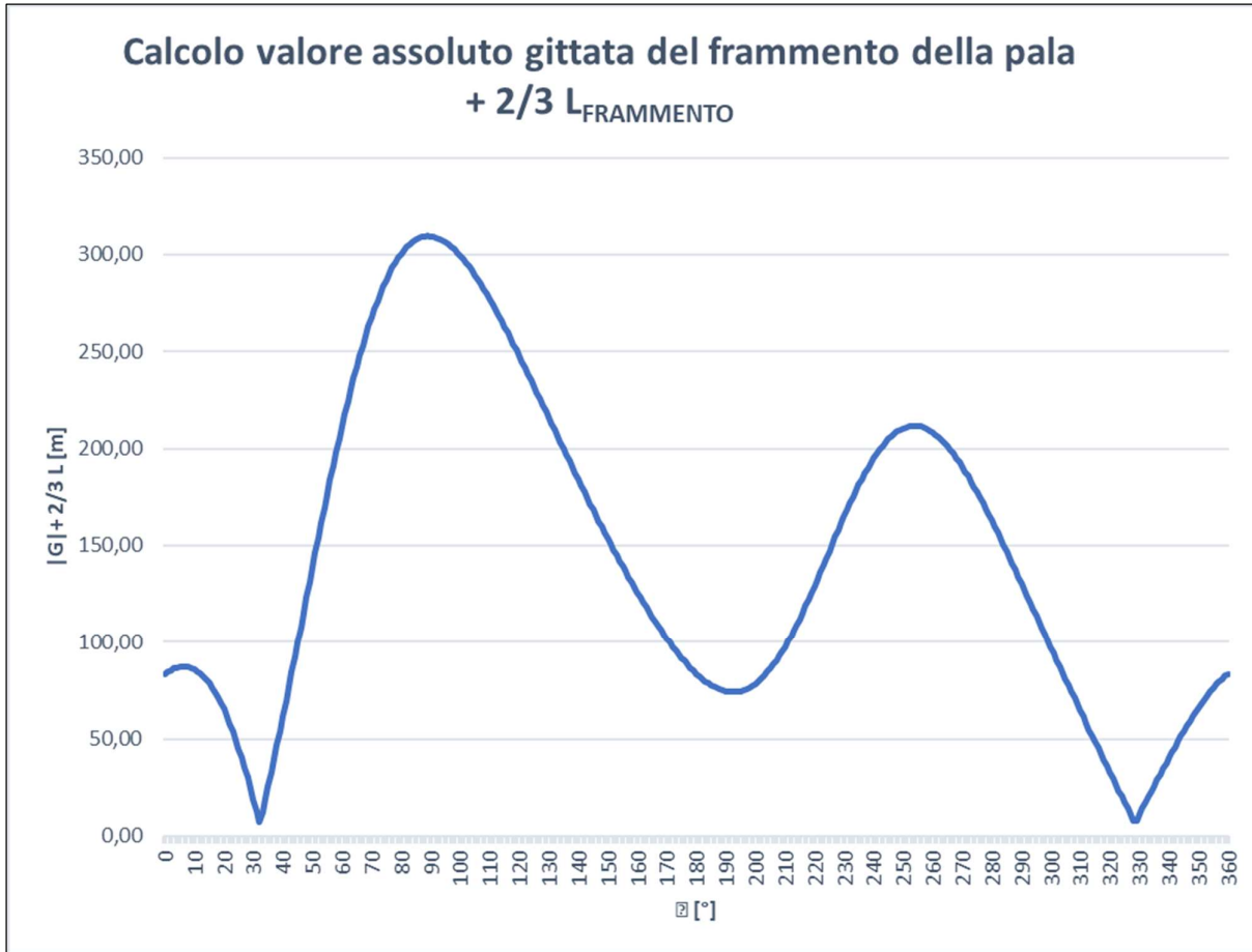
Figura 8.4: Grafico del valore assoluto della gittata del frammento della pala di lunghezza 10 m + 2/3 L_{FRAMMENTO}
