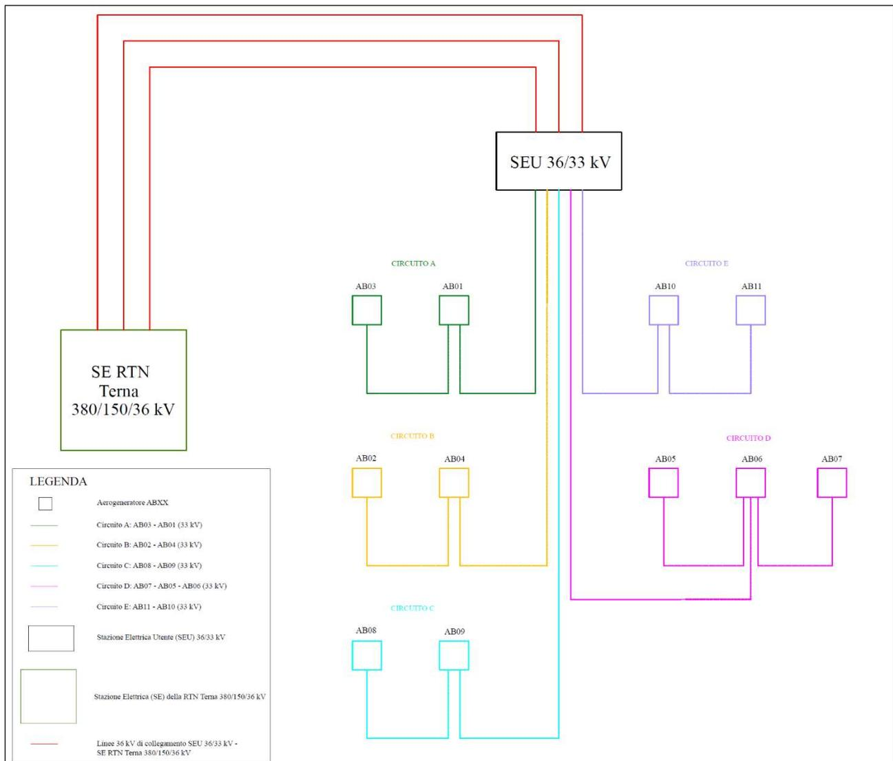
**Figura 2.3.3.1:** Schema a blocchi del Parco Eolico Abruzzo
