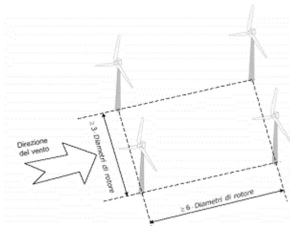
**Figura 6.1.1:** Criterio di progettazione per definizione layout
