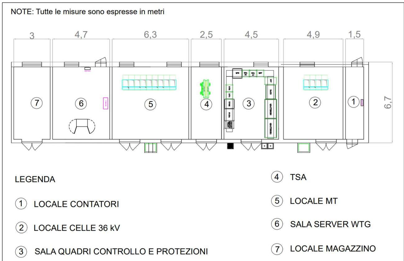
**Figura 2.3.2.2:** Pianta edificio di controllo SEU 36/33 kV
