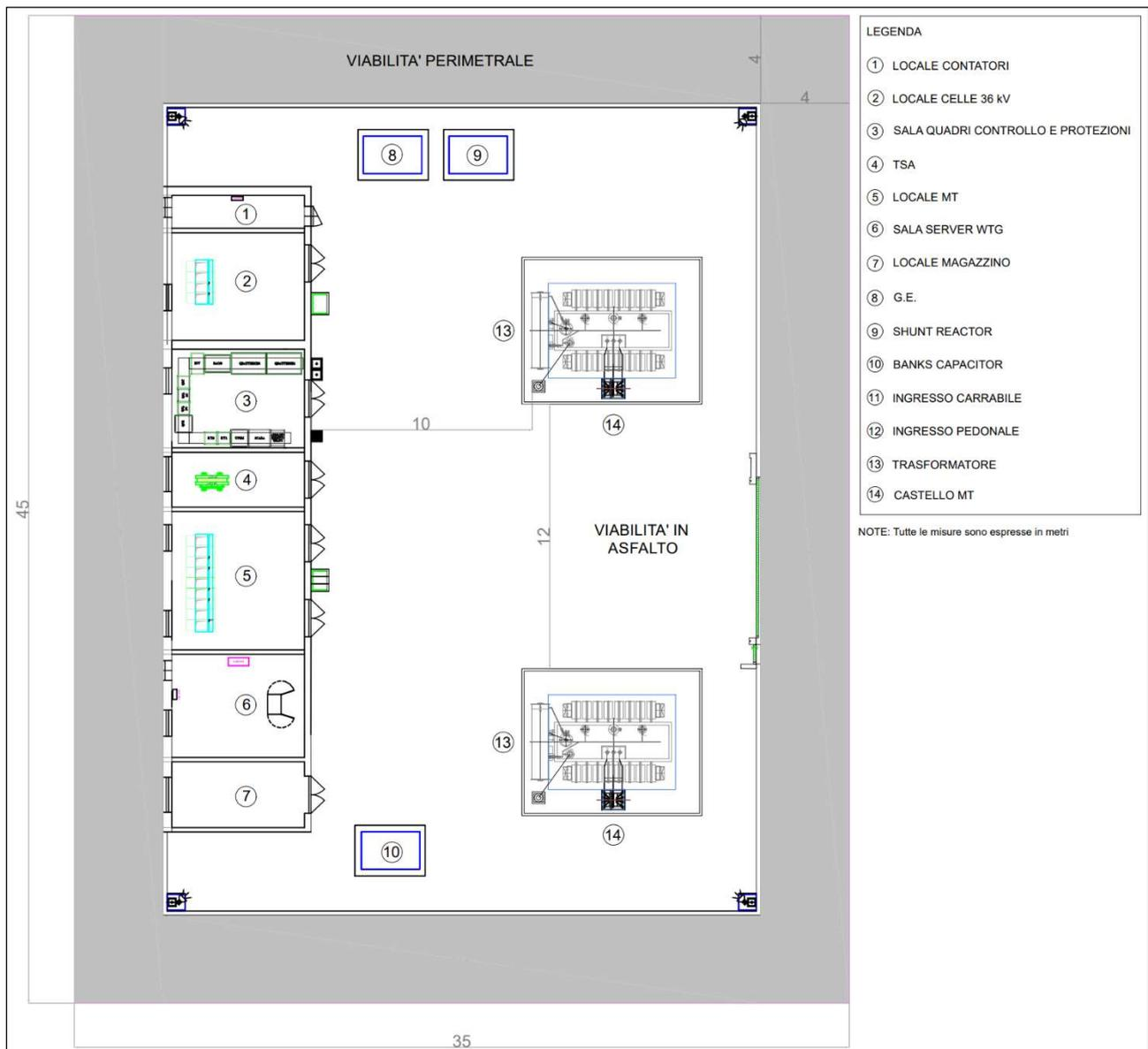
**Figura 2.3.2.1:** Planimetria elettromeccanica della Stazione Elettrica Utente 36/33 kV
