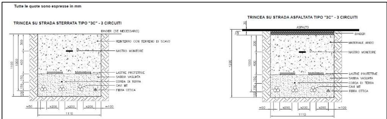
Figura 2.3.3.4: Sezioni tipiche delle trincee cavidotto per tre terne di cavi in parallelo su strada sterrata e asfaltata
