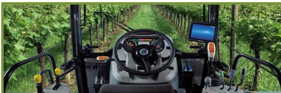
Figura 156: interno cabina trattore con strumentazione per l'agricoltura di precisione.
