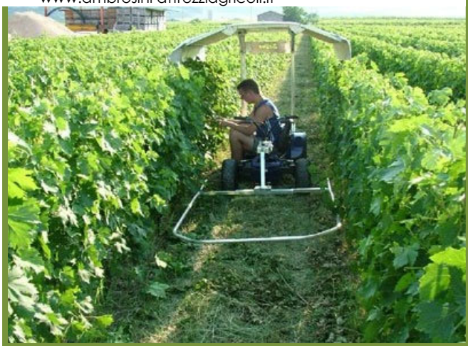
Figura 135: carrello elettrico per operazioni gestionali in vigneto utilizzabile anche per il traino carrelli raccolta
