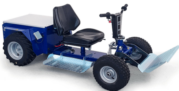
Figura 136: carrello elettrico per operazioni gestionali in vigneto utilizzabile anche per il traino carrelli raccolta Fonte: www.zallys.com
