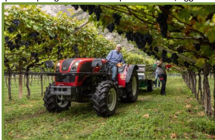
Figura 139: esempio di trattore da frutteto adatto per lavorare con uno spazio in altezza limitato.
