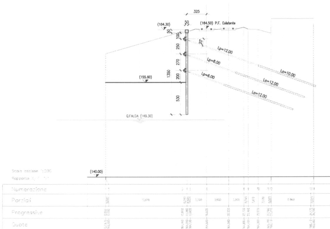
Figura 1 – schema paratia provvisoria SL05
