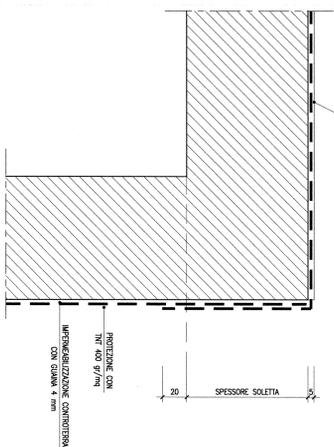
PARTICOLARE RINFORZO STRUTTURA ESISTENTE E COLLEGAMENTO
